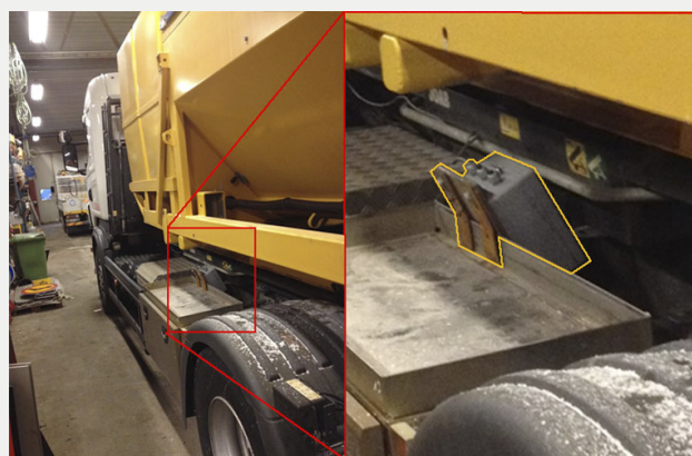
Figur 1. Saltbil med installerad IR-sensor för mätning av vattenmängd på väg under drift.
